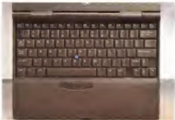
La tastiera e il micro joystick SurePoint: in alto le file di led che indicano l'accesso e stato del computer.
